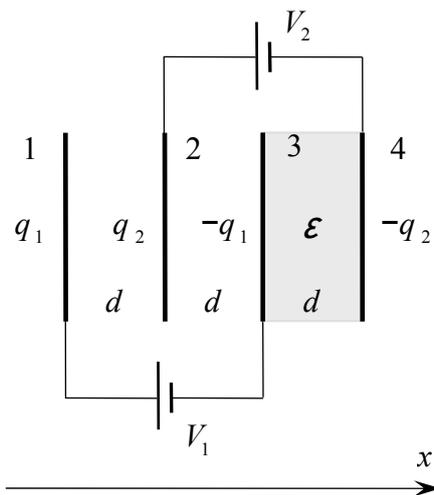
Обозначим через  $q_1$  и  $q_2$  заряды пластин 1 и 2. Тогда заряды пластин 3 и 4 равны соответственно  $-q_1$  и  $-q_2$ . Введём поверхностные плотности заряда на пластин 1 и 2:
