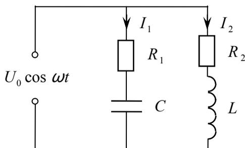
Перерисуем исходную схему, отдельно изобразив на ней сопротивление катушки  $R_2$ .
