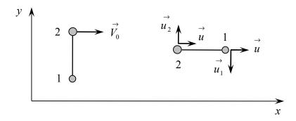
Разложим скорости шайб на составляющие, параллельные и перпендикулярные стержню в конечном положении:
