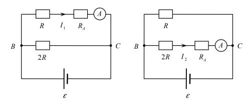
Пусть R и 2R — параллельно соединённые сопротивления. Неравенство  $I_1 \neq 2I_2$  означает, что сопротивление амперметра отлично от нуля. Обозначим его через  $R_A$ . Учитывая, что при измерении токов  $I_1$  и  $I_2$  напряжение между точками B и C равно эдс батареи  $\varepsilon$ , получаем два уравнения:
