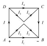
Верхний треугольник, по которому текут токи  $I_3$  и  $I_4$ , состоит из двух сопротивлений R и 2R, соединённых параллельно. Этот треугольник можно заменить одним эквивалентным сопротивлением 2R/3. Тогда полное сопротивление R' участка ADCB равно:
