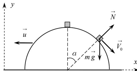
Рассмотрим движение бруска и полусферы в инерциальной системе отсчёта, связанной со столом. Ось  $x$  направим вдоль стола, ось  $y$  вертикально вверх. Так как между полусферой и столом нет трения, то горизонтальная составляющая полного импульса сохраняется:
