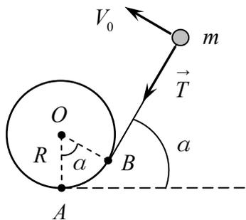
Примем за начало отсчёта времени момент начала движения шайбы. Пусть в момент времени  $t$  нить касается столба в точке  $B$  и нить повернулась на угол  $\alpha$ . Угол между радиусами  $OA$  и  $OB$  также равен  $\alpha$ . Длина участка нити от точки  $B$  до шайбы равна:
